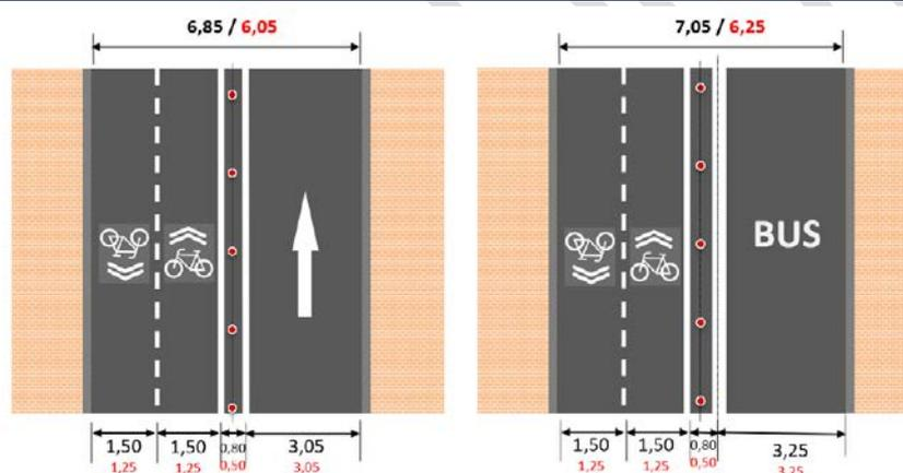
Figura 71. Dimensiones de Carril bici bidireccional sobre calzada.
