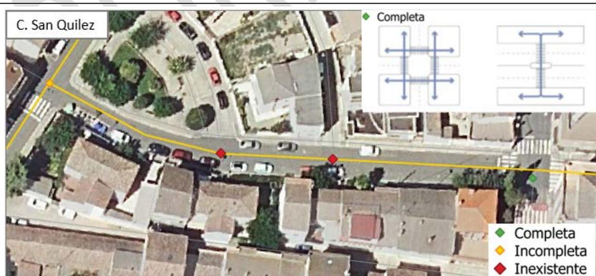
Figura 62: Esquema y ejemplo de intersección peatonal completa.
